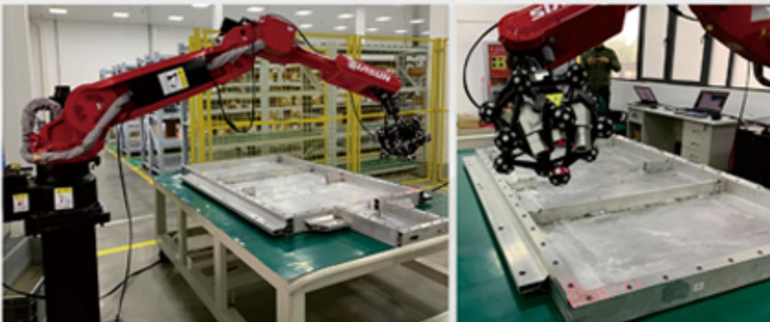
根据客户需求，我司华朗三维技术工程师制定了有效解决方案，使用华朗三维HL-Scan三维在线检测系统结合最新三维扫描技术对新能源汽车电池模组进行有效数据采，过程无需贴点、喷粉处理，操作方便，配合机器人机械臂实现自动化。
